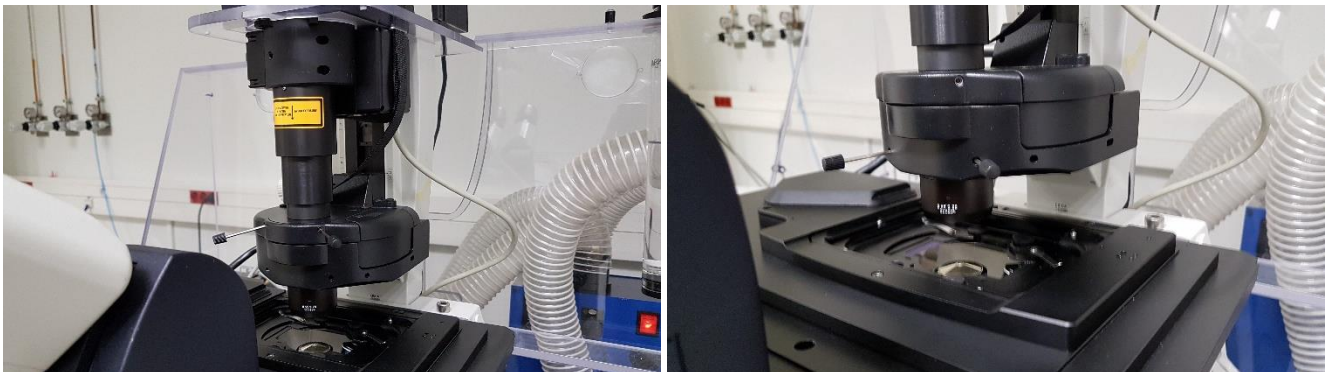
Figure 5 : Exemple d'un condenseur sur un microscope inversé (Leica DMI6000B). (a) Le condenseur. (b) Outils et vis de réglages permettant le centrage du diaphragme de champ.
