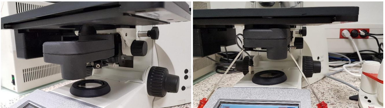
Figure 4 : Exemple d'un condenseur sur un microscope droit (Leica DM6). (a) Le condenseur. (b) Outils et vis de réglages permettant le centrage du diaphragme de champ.
